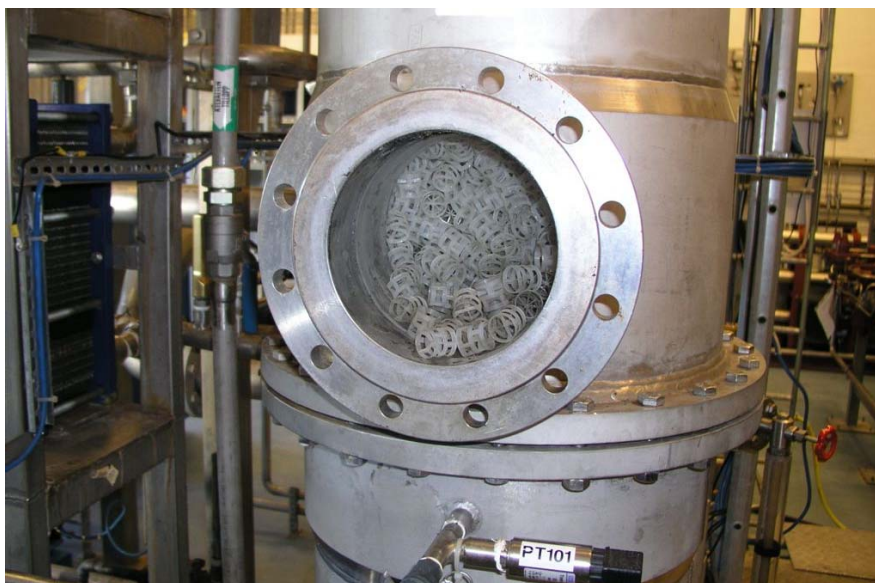
Figur 3.1 En vattenskrubberkolonn fylld med fyllkroppar. 20
